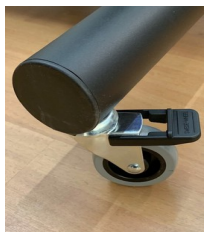
Vakiopyörä 75 mm jarrullinen Painonkesto 55 kg Valmistaja : Swede-Wheel, Ruotsi RoHS (EU)-Approved
